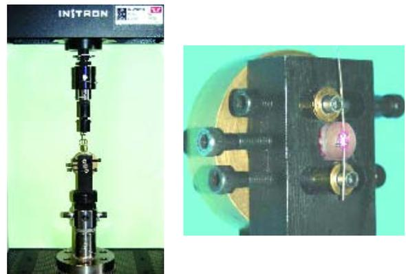
Figura 4 - Dispositivo utilizado para fixação dos fios ortodônticos ao braço móvel do Instron
