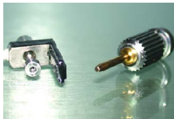
Figura 2 - Transdutor com a respectiva chave para aperto ao implante ou pilar
